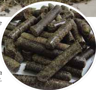
Bahan bakar briquette daripada tandan buah kosong dan tempurung sawit.
