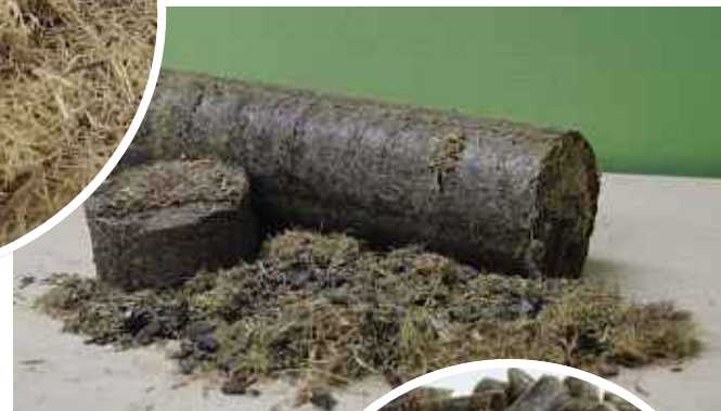
Bahan bakar briquette daripada tandan buah kosong dan tempurung sawit.
