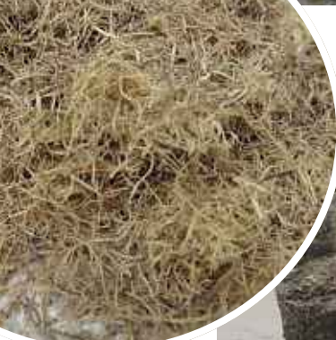
Gentian daripada tandan buah kosong selepas proses rawatan mekanikal sebagai bahan masukan proses pemampatan.
