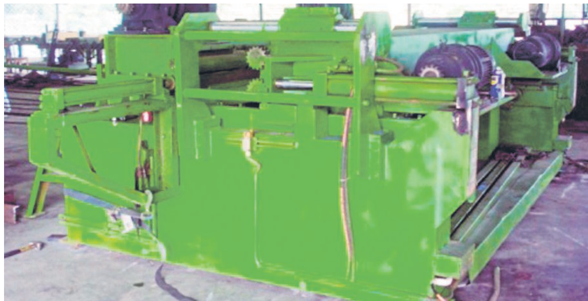
Mesin pengupas 'spindleless lathe' batang sawit mudah alih.
