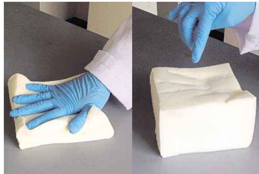
Bekas tapak tangan jelas kelihatan di atas bantal Memory Foam selepas ujian mampatan.
