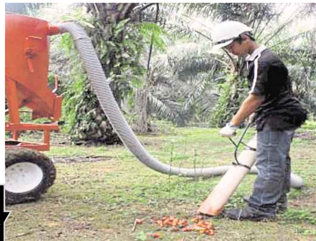
Mesin pengutip buah sawit lerai mampu mengutip sebanyak 1,200 hingga 1,500 kg buah sawit lerai bagi tempoh 8 jam bekerja dengan kandungan kurang 15 peratus sampah berbanding dengan 250 kg hingga 300 kg bagi tempoh yang sama.
