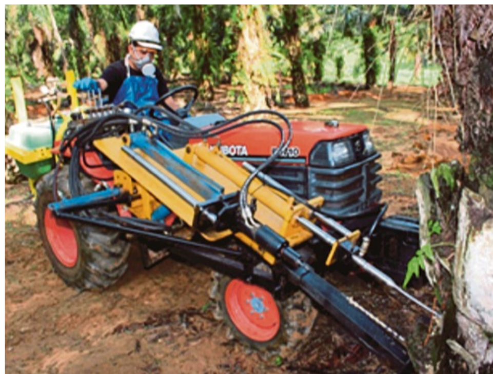
Jentera Penyuntik Batang Sawit dapat melakukan kerja menyuntik dengan lebih cekap dan berkesan.
