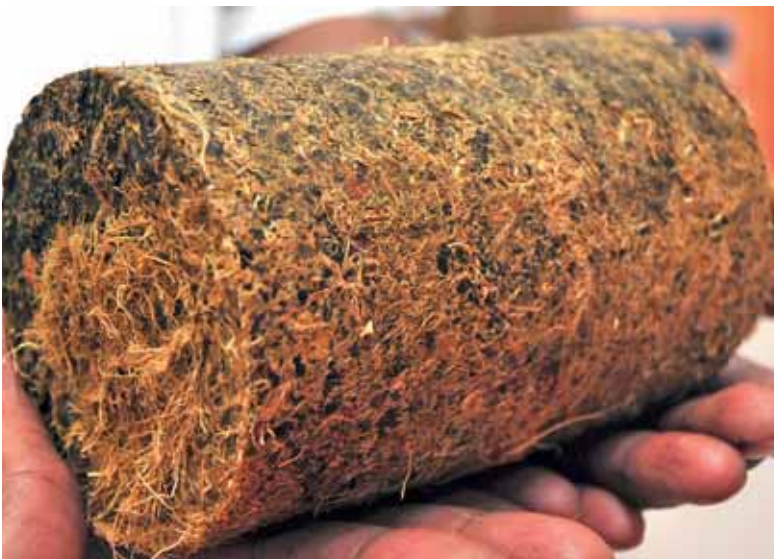
BAHAN bakar briquette sawit dihasilkan daripada gentian tandan buah kosong (EFB) dan tempurung sawit menggunakan teknologi penekan piston.
